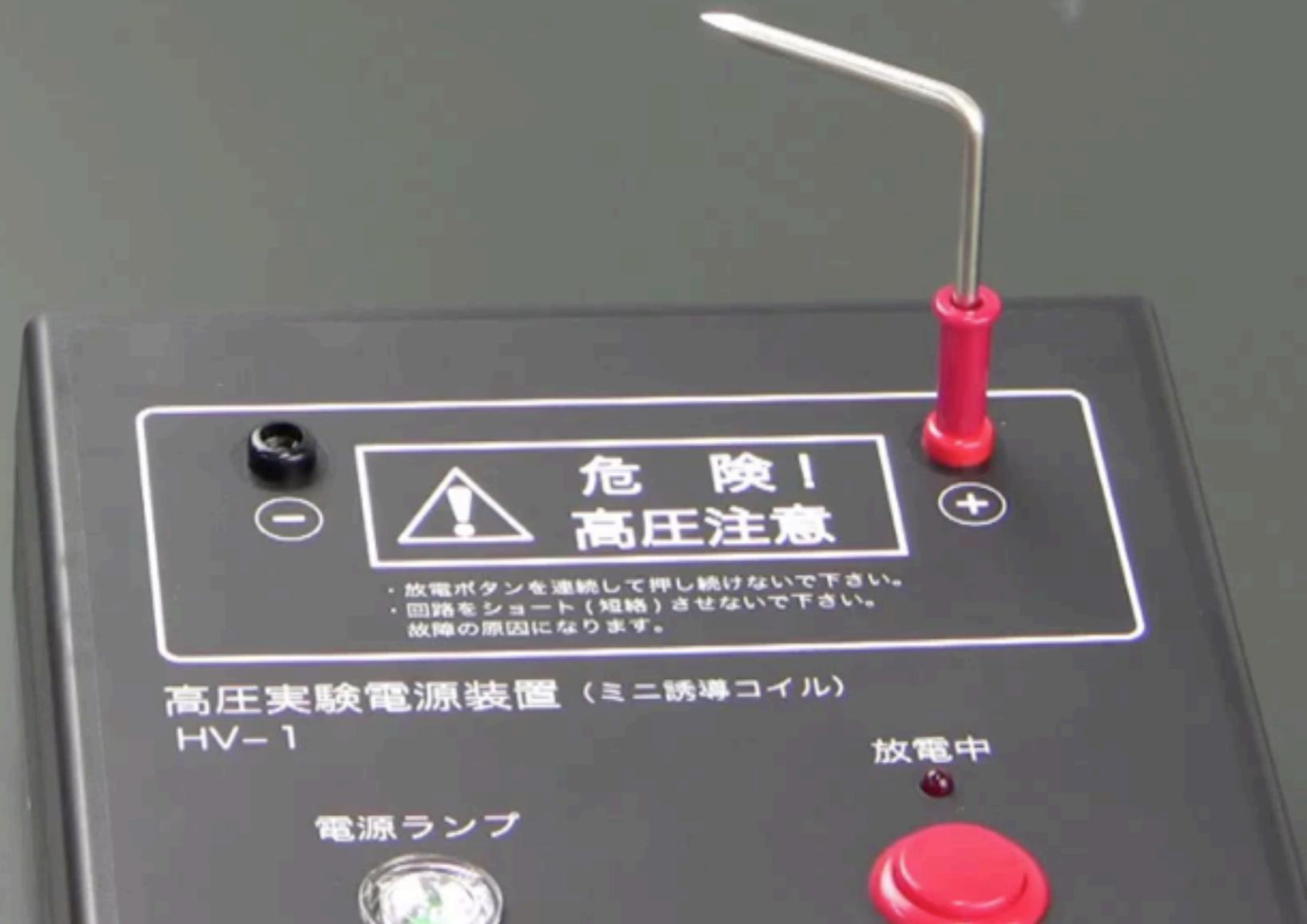
絶縁破壊電場: 0.5-3 MV/m (尖った針-平行平板)
